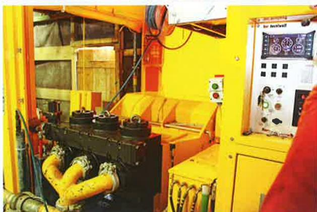
Diese Hochdruckpumpe befördert mit einem Druck von ca. 900 bar die Suspension für die DSV-Körper zu den Bohrgeräten.
